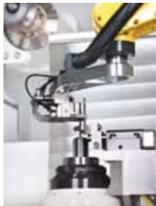
Dvojitě chapadlo robotu jednotky RC 1250 zaručuje minimální časy výměny
